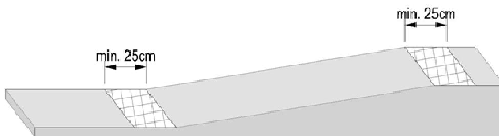
Rys. 5. Oznaczenia ostrzegawcze w miejscach zmiany przekroju.
