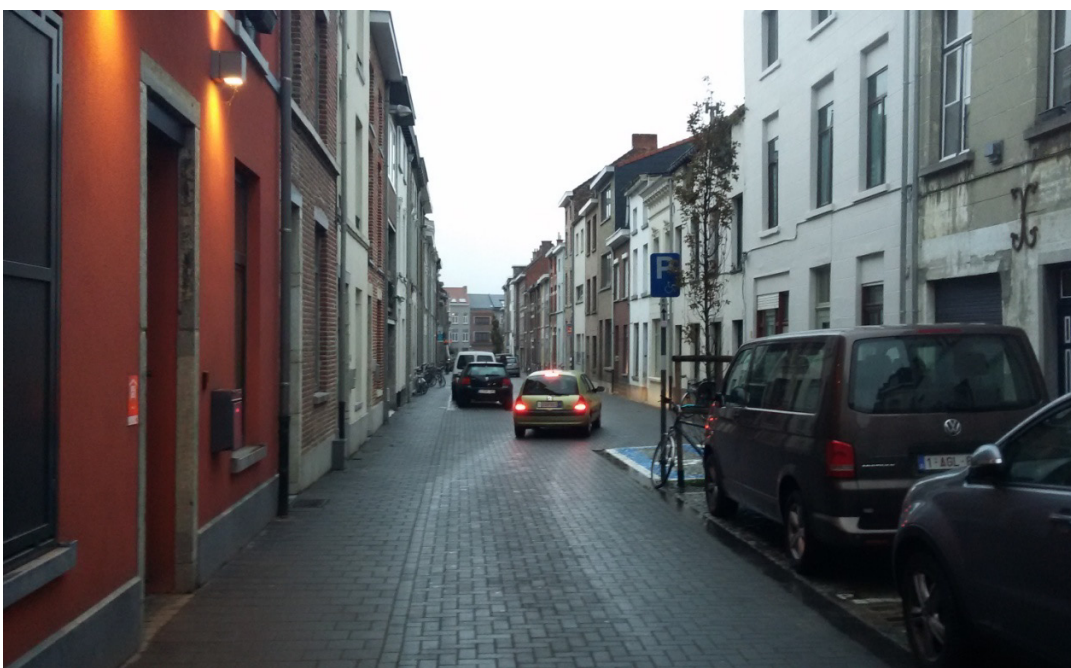
Rysunek 5.4 Sposoby wymuszania redukcji prędkości - przerwanie ciągłości ulicy dla samochodów oraz przestrzeń wspólna z naprzemiennym parkowaniem Źródło: zasoby VIA VISTULA
