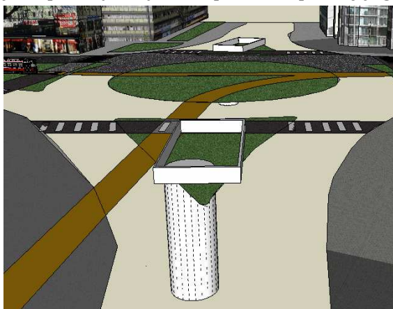
Rysunek 2. 4 Wydrążenie pionowych szybów do poziomu zapewniającego budowę galerii
